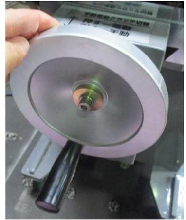
コンクリート・岩石などの円柱供試体端面を自動で研磨を行うことによりお客様の試験業務効率化をサポートします。対応供試体はΦ15cm、Φ12.5cm、Φ10cm、オプション治具でΦ5cmまで対応。供試体のセットは上部レバーのワンタッチでしっかり固定。供試体押さえフレームの高さも調整も簡単に行うことができます。供試体研磨が終了すると、スタート位置まで自動的に戻るオートリターン方式を採用しており研磨作業を監視することなく他の作業を行うことで業務効率を上げることが出来ます。
